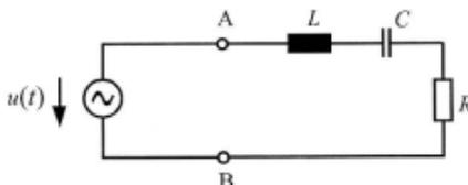
Im Folgenden sollen alle Ergebnisse in Abhängigkeit von den Werten von  $R$ ,  $L$  und  $C$  sowie Effektivwert  $\underline{U}$  und Kreisfrequenz  $\omega$  der Spannungsquelle  $u(t)$  bestimmt werden, die als bekannt vorausgesetzt werden.
